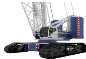
ラチスブーム式クローラクレーン
