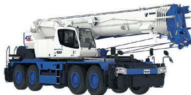
ラフテレーンクレーン
