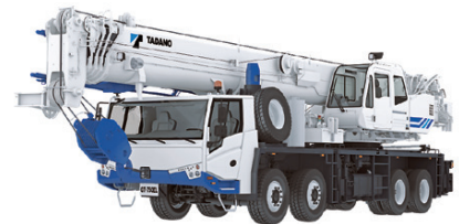
トラッククレーン
