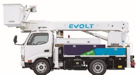
電動高所作業車
