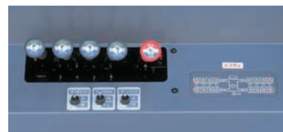
▲アウトリガインジケータは張出状況を個別に検出し、表示します。
