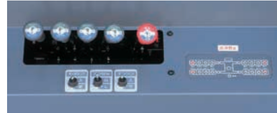
アウトリガインジケータは張出状況を個別に検出し、表示します。
