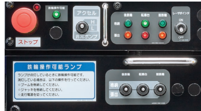
張出・格納操作部(転車台・鉄輪)
