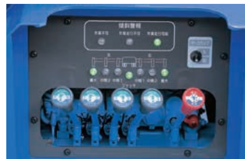
アウトリガ操作部とアウトリガインジケータ(写真:BT-110)
