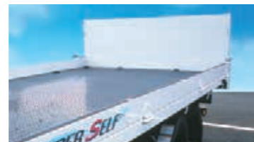
125mm 開閉式横アオリと700mm 全面縞鋼板張道板
