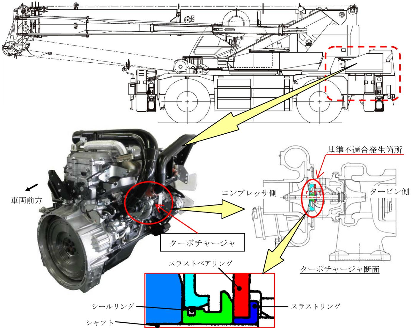
ホイールクレーンの原動機において、エンジンオイルの潤滑性が低下した状況下におけるターボチャージャのスラストベアリングの耐久性が不足しているため、当該状況下で繰り返しエンジンに高負荷を加えたり高回転域で使用すると、スラストベアリングおよびスラストリングに摩耗を生じることがある。そのため、ターボチャージャのシャフトにガタつきが生じ、そのままの状態で使用を続けると、ターボチャージャのシールリングが損傷してエンジンオイルが漏れ出し、当該オイルがエンジン内部、排気系に入り込み、白煙、異音、エンジン回転数の上昇等の不具合が発生し、最悪の場合、エンジンが破損するおそれがある。
