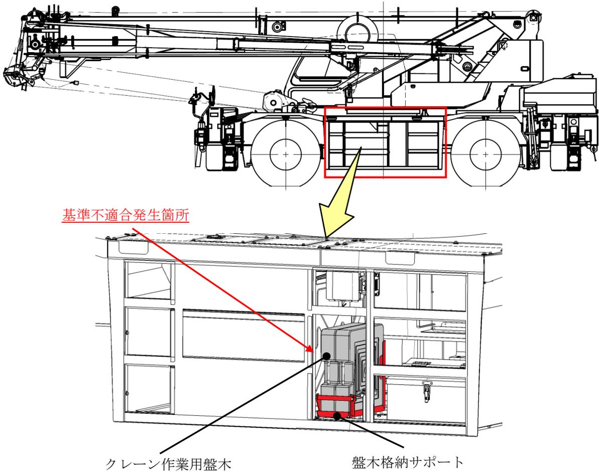
ホイール・クレーンの車枠に取り付けたクレーン作業用の盤木格納サポートにおいて、サポートの固定方法が不適切なため、固定ボルトに緩みが生じるおそれがある。そのため、そのままの状態で使用を続けた場合、固定ボルトが外れ、最悪の場合、走行中に盤木格納サポートおよび盤木が車体からはみ出し、他の交通を妨げるおそれがある。
