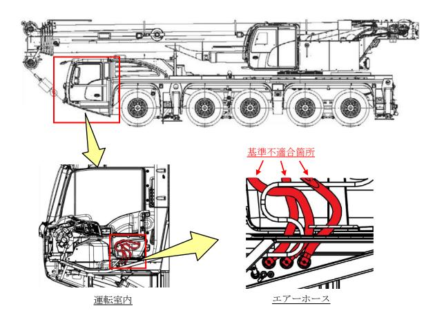
クレーン車の駐車ブレーキ用エアーホースにおいて、エアーホース接続金具部の加締め工程が不適切なため、ホース加締め部のゴムが損傷することがある。そのため、そのままの状態で使用を続けると、損傷部よりエアーが漏れ、駐車ブレーキが解放できなくなるおそれがある。
