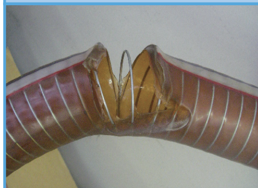
油圧ホースの損傷例
