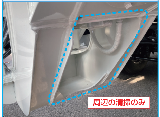
ポスト先端下部 (BT-100・BT-110) 開口部の目視点検
