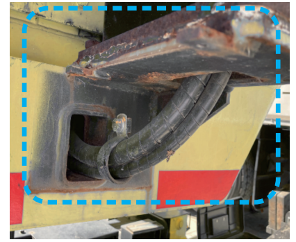
ポスト先端下部 (BT-100・BT-110) 開口部の目視点検
